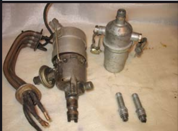
Ekranizowana instalacja zapłonowa.
