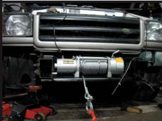
Wyciągarka w trakcie montażu.
